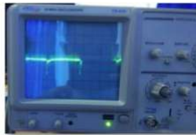
Gambar 9. bentuk gelombang PWM pada saat potensiometer diputar 50 %
