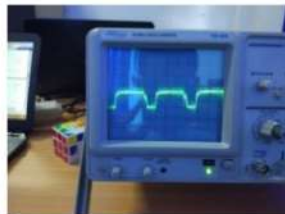
Gambar 10 bentuk gelombang PWM pada saat potensiometer diputar 75 %
