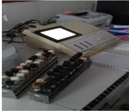
**Gambar 3.5.** Pengujian COD dengan Spektrofotometer (dokumentasi penelitian 2018)
