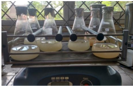
3. Proses pengadukan dengan shaker selama 30, 60 dan 90 menit
