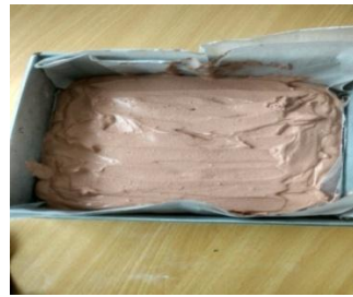
4. Bentonit dikeringkan dengan sinar matahari.
