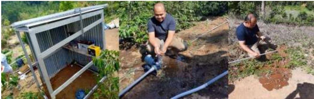
Gambar V.4 Pengujian plts untuk menghidupkan pompa air listrik
