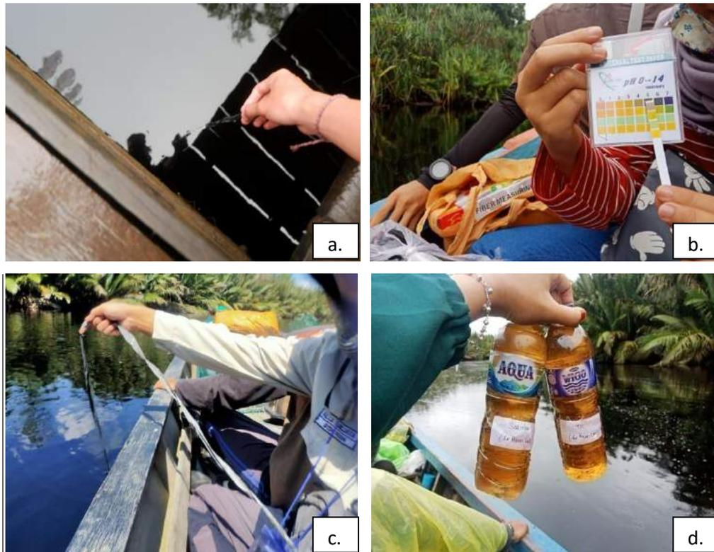
Gambar 14. (a). Pengukuran suhu air, (b). Pengukuran pH air, (c). Pengukuran suhu lingkungan, (d). pengambilan sampel air
