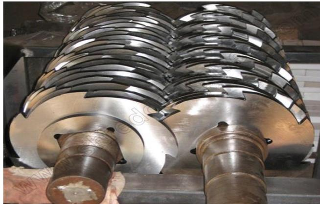
Gambar 5. Pencacah *type shredder* (Hadi, 2001).
