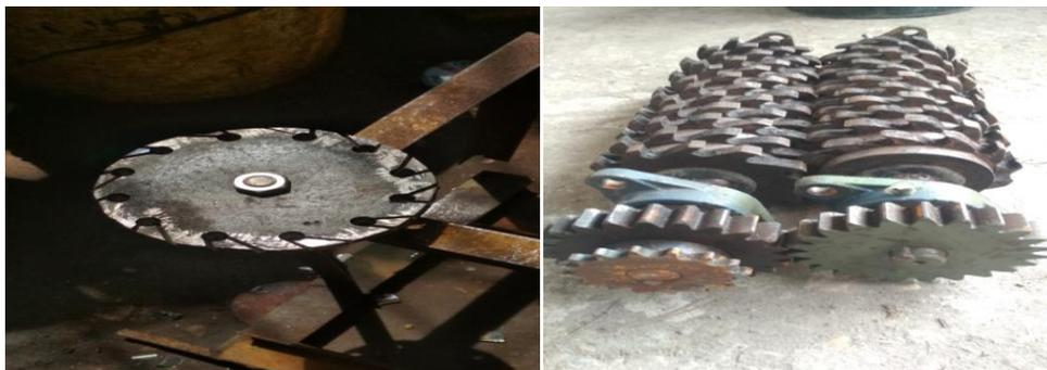
Gambar 6. Unit pencacah *shredder*
