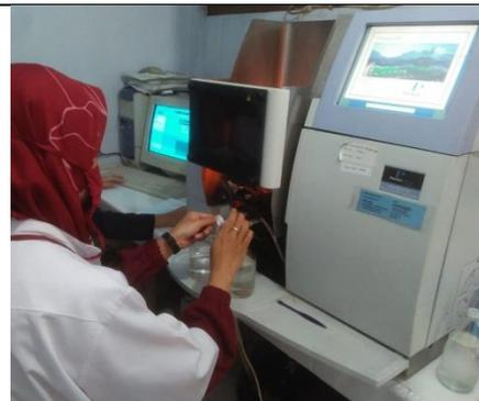
(Gambar 10. Uji logam besi (Fe) menggunakan *Atomic Absorption Spectrophotometer* (AAS))
