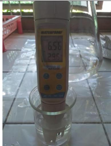
(Gambar 6. Pengecekan pH setelah adsorpsi)
