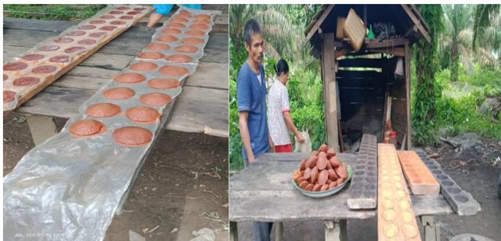
Gambar VI Sebelah Kiri Proses Pendinginan Dan Sebelah Kanan Adalah Sudah Mengeras dan Dilepaskan Dari Cetakan. (Sumber Dokumentasi Pribadi).
