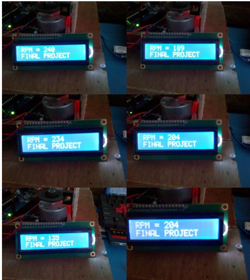
Lampiran 3. Gambar Pengukuran Kecepatan Menggunakan Sensor LM393
