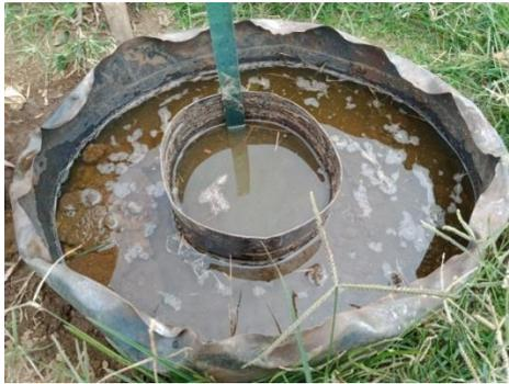
Gambar 7. Titik Uji Infiltrasi Kedua Pada Bentuk Lahan Lembah Struktural dengan Kelerengan 40-160 (Curam-Terjal)
