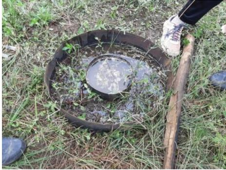
Gambar 6. Titik Uji Infiltrasi Pertama Pada Bentuk Lahan Lereng Vulkanik Dengan Kelerengan 40-160 (Landai-Curam)
