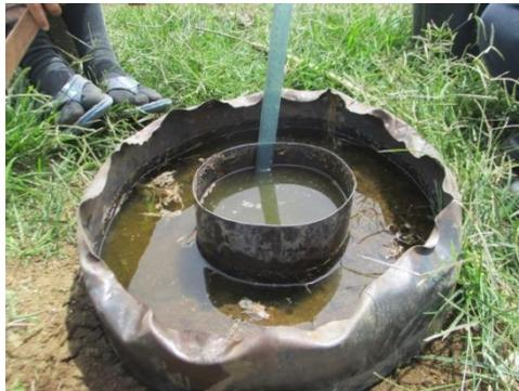
Gambar 8. Titik Uji Infiltrasi Ketiga Pada Bentuk Lahan Lembah Struktural dengan Kelerengan 160-550 (Terjal)
