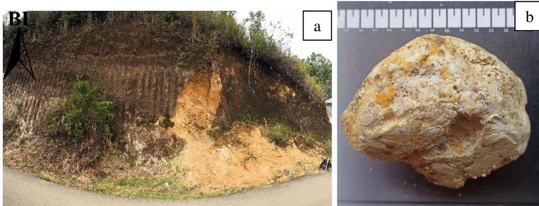
**Gambar 38.** (a). Bentang alam singkapan alterasi argilik, (b). Foto dekat sampel alterasi argilik.
