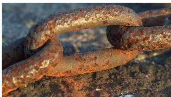
Pernahkah kalian melihat benda-benda yang rusak karena korosi? Korosi atau perkaratan biasa kita lihat pada logam besi yang dibiarkan begitu saja. Terjadi karena adanya kontak langsung dengan air dan oksigen, sehingga besi teroksidasi yang akhirnya mengalami korosi. Tapi?? Apakah semua reaksi kimia menggunakan oksigen? Apakah reaksi yang menggunakan oksigen saja yang dapat mengalami oksidasi dan reduksi? Bagaimana dengan oksidasi dan reduksi pada reaksi lain yang tidak menggunakan oksigen?
