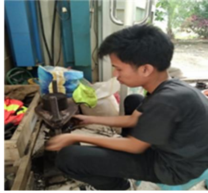
8. Keluarkan tanah dari cetakan menggunakan dongkrak
