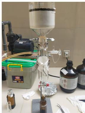
**Gambar 4.3** Proses fraksinasi menggunakan KCV
