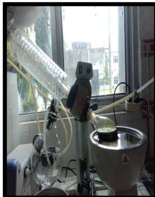
8. Penguapan maserat dengan rotary evaporator
