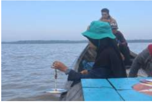
Proses Pengukuran Parameter Lingkungan, yaitu Kecerahan
