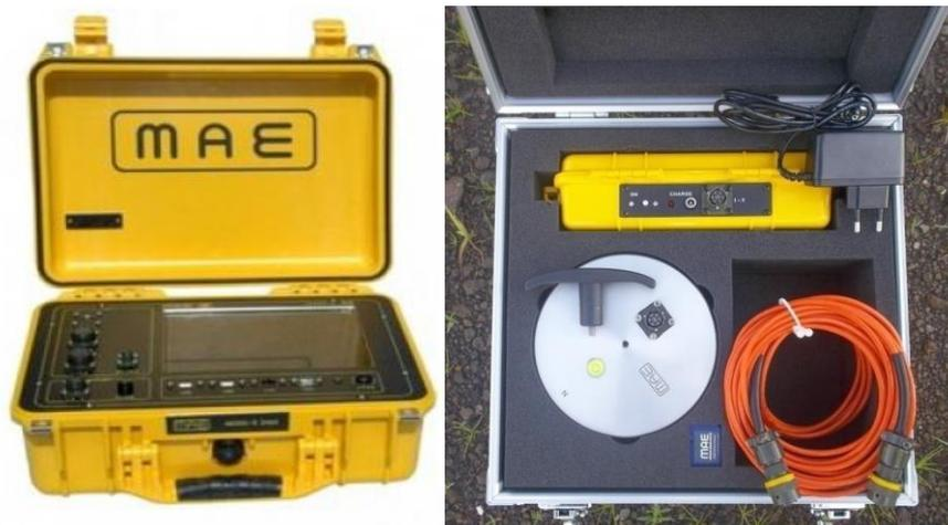
**Gambar 8.** Seismograf MAE A6000S dan Perangkat Alat Mikrotremor
