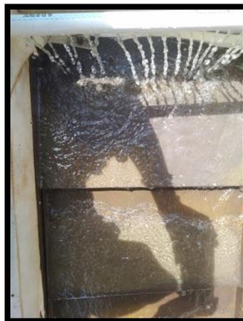
**Gambar 26.** Aliran air keluar dari pipa pada *Sluice box* 1.0
