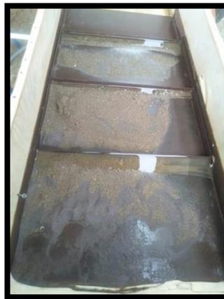
**Gambar 24.** Hasil Pencucian dengan *Sluice box* 1.0 pada kemiringan 2°
