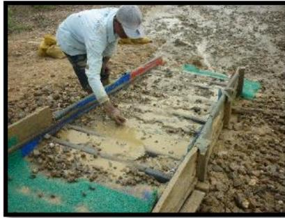
**Gambar 3.** Pencucian Mineral dengan *Sluice box*
