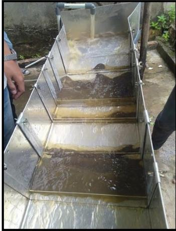
Proses pencucian bijih timah menggunakan alat *sluice box 2.0*
