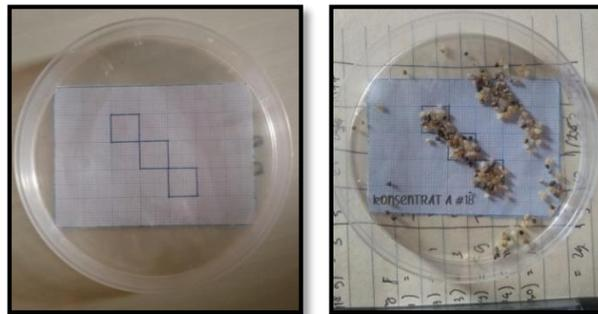
**Gambar 23.** Grid dalam analisis *Grain Counting*
