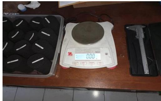
b. Pengukuran dimensi untuk mengukur kerapatan
