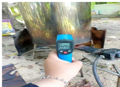
e. Pengukuran suhu pengarangan bambu
