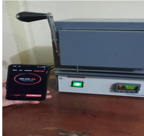
e. pengujian kadar zat menguap
