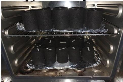
a. Pengovenan briket arang untuk pengujian kadar air
