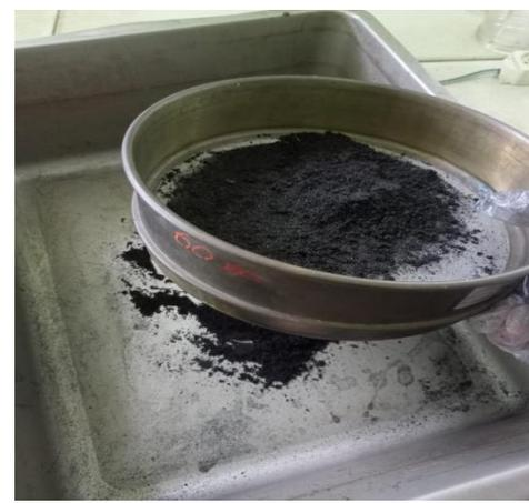
b. Proses penyaringan arang yang telah digiling menggunakan saringan 60 mesh
