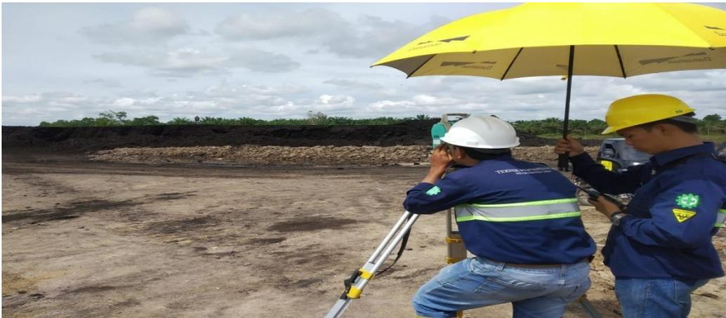
**Gambar 26.** Proses Pengambilan Data Menggunakan Total Station
