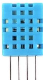
**Gambar 9.** Sensor DHT 11
