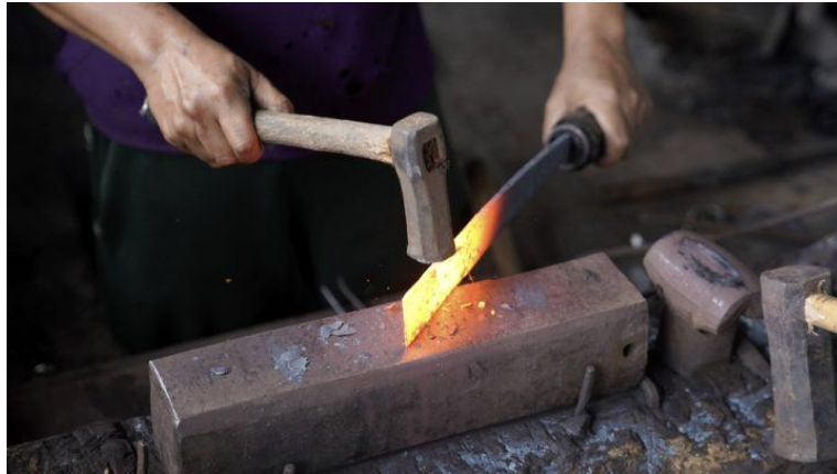
Gambar 1. Proses pemanasan besi
