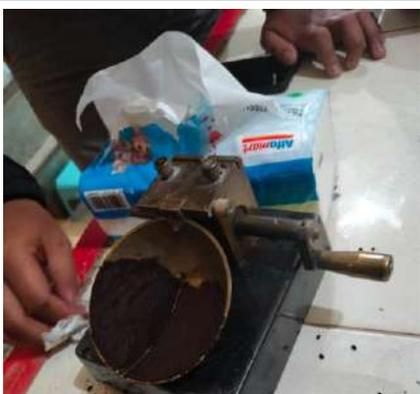
5. Buat alur dengan *grooving tool* hingga tanah terbelah menjadi 2. Lalu putar *handle* mangkuk *cassagrande* dengan kecepatan konstan, sambil menghitung jumlah ketukan
