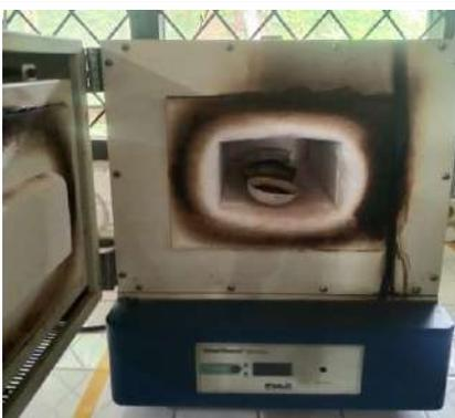
5. Setelah ditimbang, sampel dibakar dengan *furnace* pada suhu  $440^{\circ}\text{C}$  untuk mendapatkan abu
