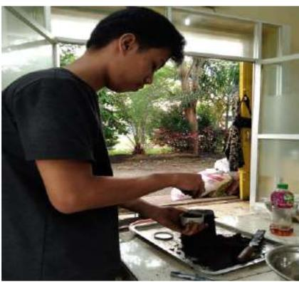
9. Pengambilan sampel pengujian untuk kadar air.
