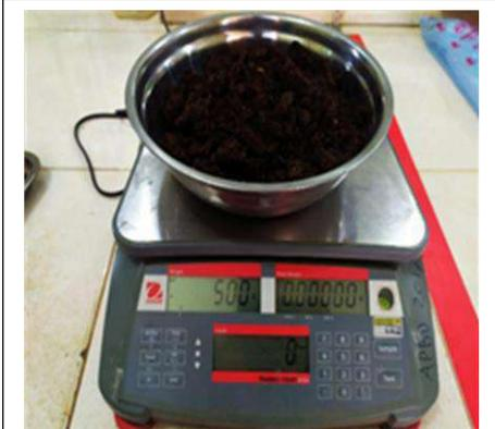
1. Timbang sampel tanah kering oven sebanyak 500gr untuk pengujian Analisa saringan
