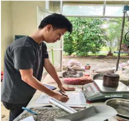
7. Timbang cetakan + tanah basah
