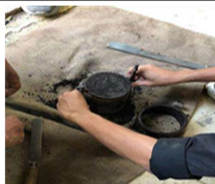
6. Setelah tanah ditumbuk buka cetakan dan ratakan tanah lalu di timbang
