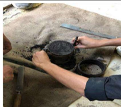
6. Setelah tanah ditumbuk buka cetakan dan ratakan tanah
