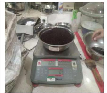
1. Ambil sedikit sampel tanah yang akan digunakan untuk pengujian CBR untuk diuji kadar air mula-mula
