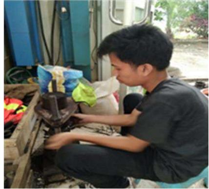
8. Keluarkan tanah dari cetakan menggunakan dongkrak
