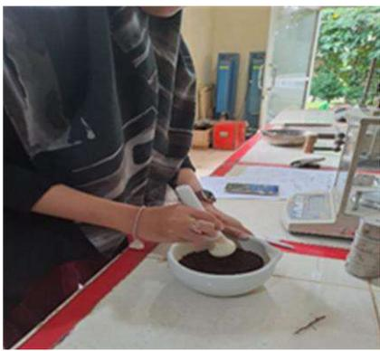
3. Mempersiapkan tanah gambut dengan di tumbuk agar tanah lolos saringan No.40, selanjutnya disaring lolos saringan No.40
