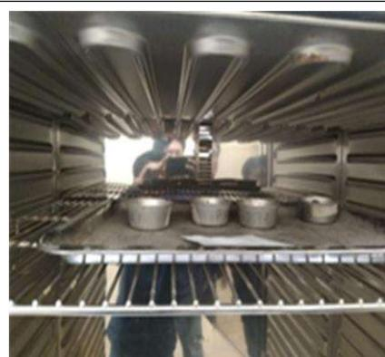
6. Tanah diambil dan dimasukkan kedalam cawan, ditimbang dan selanjutnya di oven selama 24 jam. Setelah di oven tanah yang telah kering ditimbang Kembali.
