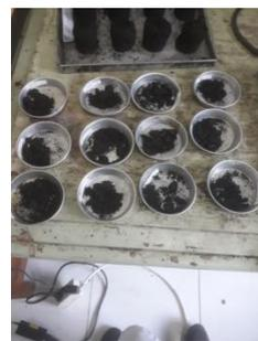
Pengeringan briket untuk uji kadar air
