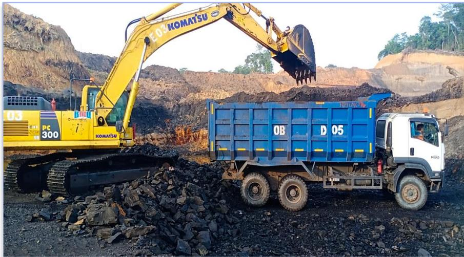
**Gambar 6. Pola Pemuatan *Top Loading* dikombinasikan dengan *Single Back Up***
