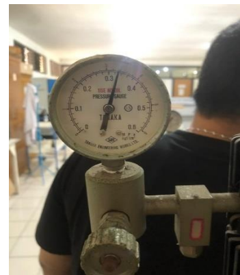
Tekanan gas CO_2 untuk laju alir 10 L/Menit
