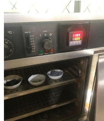
Dikeringkan hasil filtrasi menggunakan suhu 105°C selama 8 jam
