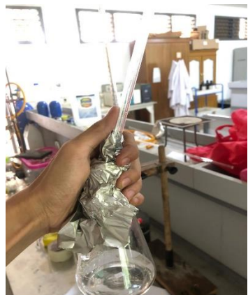
Penutupan menggunakan aluminium foil pada erlenmeyer berisi NaOH pasca penyerapan
