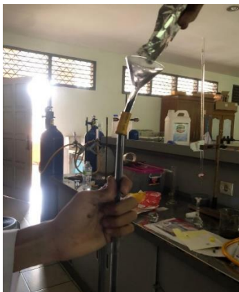
Dimasukkan 6 g biochar ke dalam packed column
