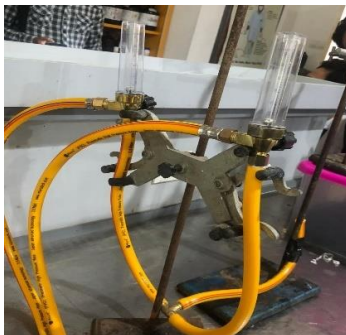
Flowmeter gas N_2 dan CO_2
