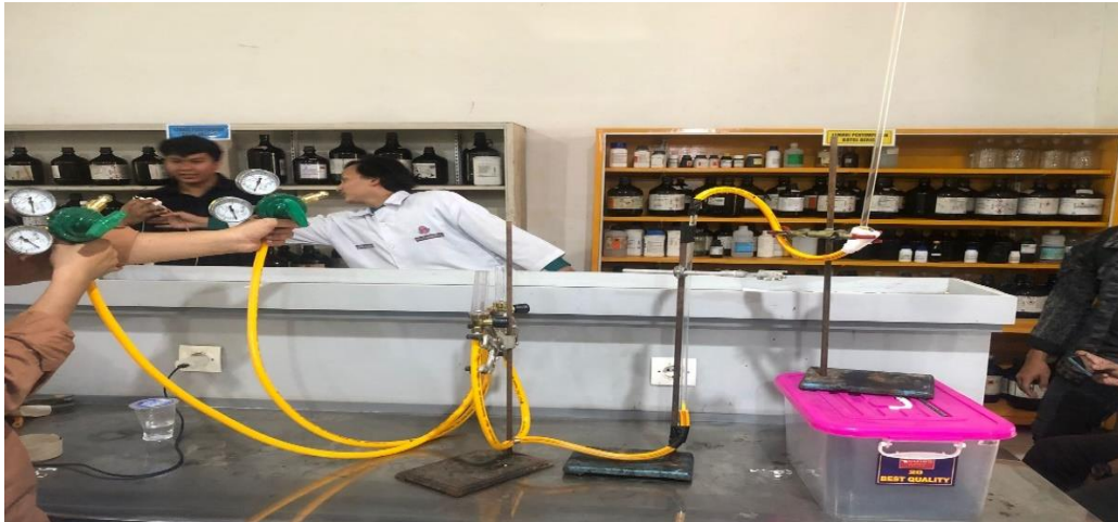
Rangkaian alat Capture CO 2 sebelum dikontakkan dengan biochar , larutan NaOH dan tabung berisi gas N 2 dan CO 2
