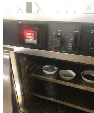
Dikeringkan hasil filtrasi menggunakan suhu 105°C selama 4 jam
