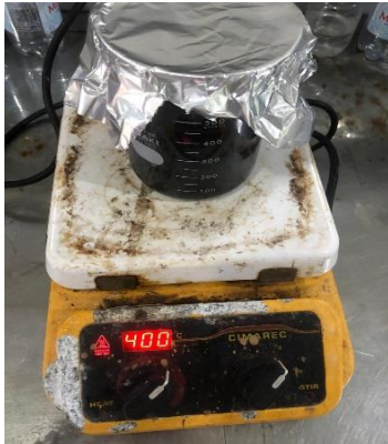
Dicampur 1 g melamin sianurat dan biochar aktivasi 2N menggunakan magnetic stirrer hotplate
