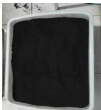
Hasil biochar yang telah dihaluskan dan diayak 200 mesh
