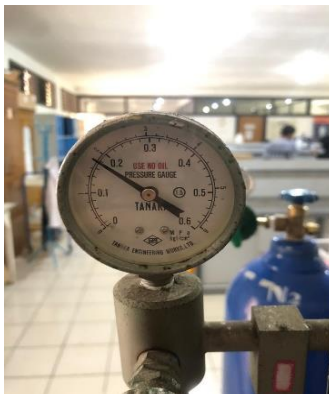
Tekanan gas CO_2 untuk laju alir gas CO_2 3 L/Menit
