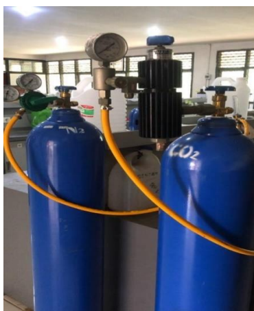
Gambar 18. Tabung gas \text{CO}_2 dan \text{N}_2 yang masing-masing telah dipasangkan regulator gas
