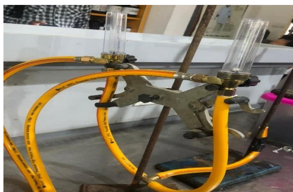
Gambar 17. Flowmeter gas CO 2 dan N 2 yang telah dirakit
