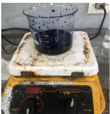
Dicampur metilen biru 1 g dengan akuades 200 mL menggunakan magnetic stirrer hotplate
