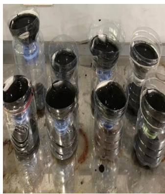
Dipisahkan dengan filtrasi hingga mencapai pH netral
