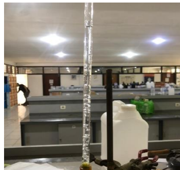
Gas CO_2 didalam larutan NaOH pada saat proses penyerapan gas CO_2
