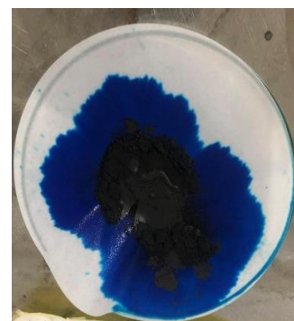
Hasil tetesan metilen biru pada N-Doped modified biochar diatas kertas saring
