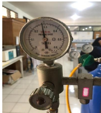
Tekanan gas CO_2 untuk laju alir gas CO_2 7 L/Menit
