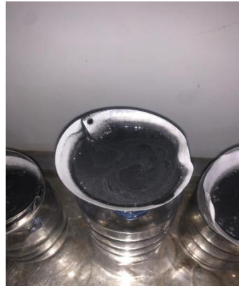
Dipisahkan dengan filtrasi hingga mencapai pH netral
