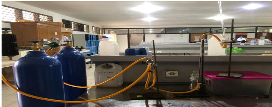
Gambar 19. Rangkaian Alat Capture CO 2 pada fixed-bed N-doped modified biochar dan NaOH absorber purging bubble
