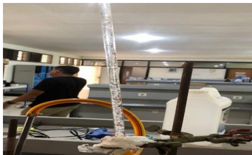
Gambar 20. Gelembung gas CO 2 dalam larutan NaOH pada packed column
