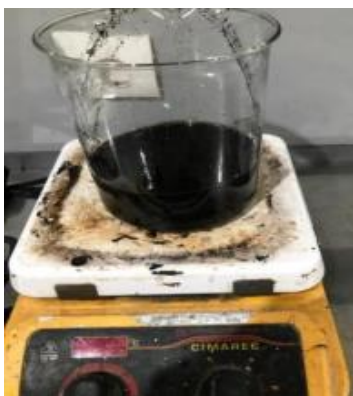
Dicampur KOH 40 mL dan Biochar , diaduk menggunakan magnetic stirrer
