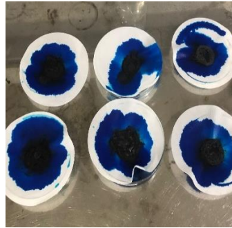
Uji MB Spot pengulangan 2 dan 3 yang telah ditetesi metilen biru dan terbentuk agregat
