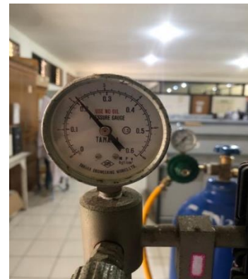
Tekanan gas CO_2 untuk laju alir gas CO_2 5 L/Menit
