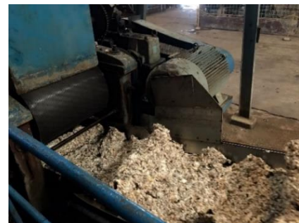
Gambar 4.4 Proses peremahan di mesin shredder dan penggilingan di mesin mangel jumbo
