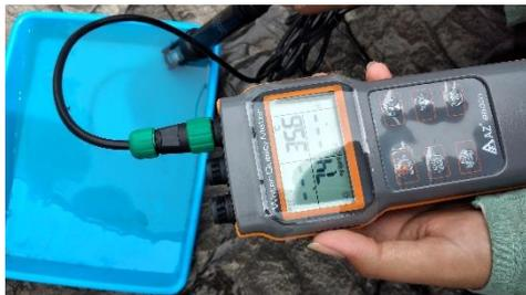
Proses pengukuran Oksigen terlarut
