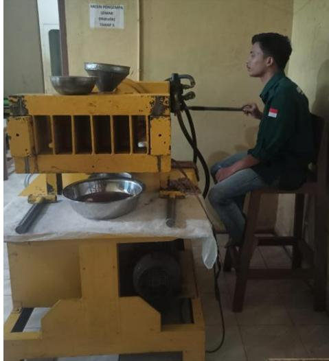
Gambar 12. Mesin Pengempa
