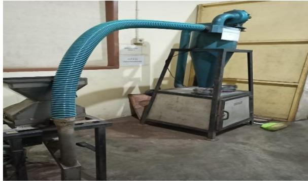
Gambar 25. Mesin Pemecah Kulit
