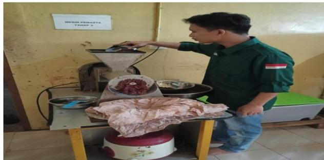
Gambar 26. Mesin pemasta
