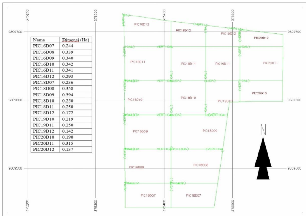
Gambar 9. Batterblok (Blok) Pit Tahun 2023
