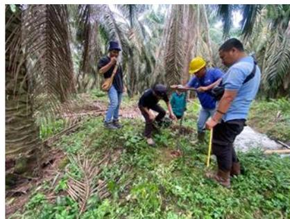
Pengambilan sampel tanah di antara rorak dan tanaman menggunakan bor tanah
