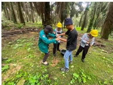
Pengambilan sampel tanah di lahan kontrol menggunakan bor tanah
