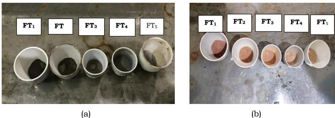
**Gambar 14.** Sampel (a) Sebelum dikalsinasi; (b) Setelah dikalsinasi
