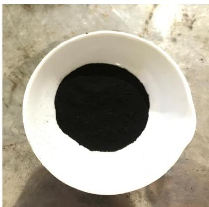
**Gambar 2.** Magnetit ( $\text{Fe}_3\text{O}_4$ )
