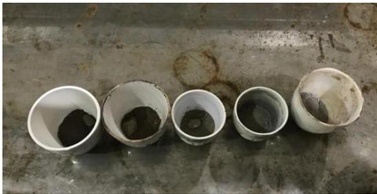
Pembuatan  $\text{Fe}_3\text{O}_4$  dan  $\text{TiO}_2$  setelah digerus selama 2 jam
