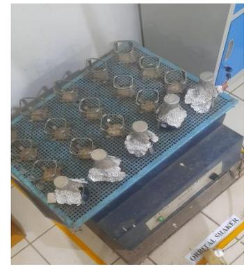
Proses Adsorpsi dengan Orbital Shaker
