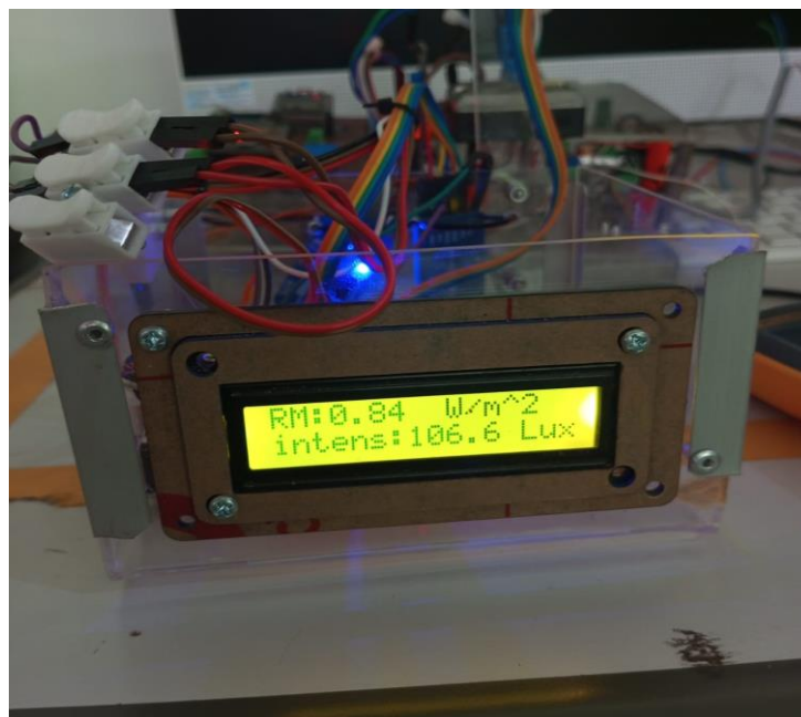
Lampiran 2. Tampilan data radiasi dan lux terukur oleh alat perancangan
