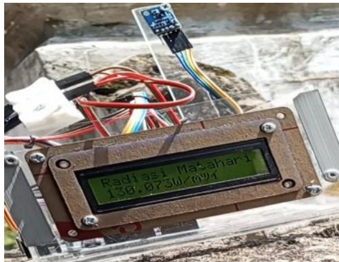
Gambar 23. Tampilan nilai radiasi saat pengukuran
