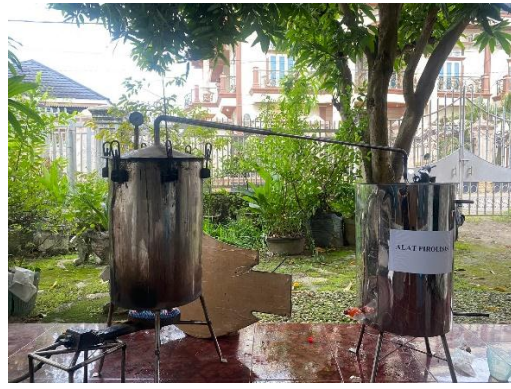
Proses pembuatan asap cair serbuk rengas
