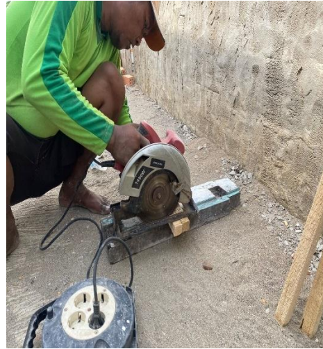
Pembuatan sampel uji berukuran 2,5 x 2,5 x 5 cm
