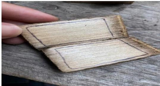
Gambar 11. Pengujian penetrasi asap cair serbuk rengas
