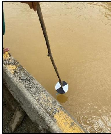
**Gambar 2.** Pengukuran kecerahan menggunakan *Secchi Disk*
