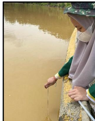
**Gambar 3.** Pengukuran suhu air menggunakan *Thermometer* batang
