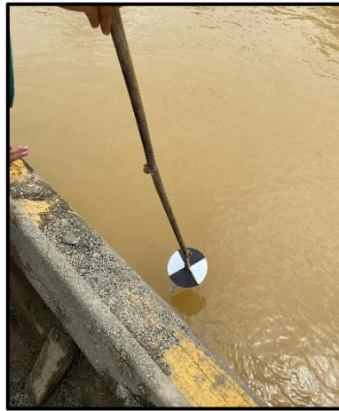
Gambar 2. Pengukuran kecerahan menggunakan Secchi Disk
