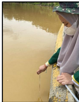
Gambar 3. Pengukuran suhu air menggunakan Thermometer batang
