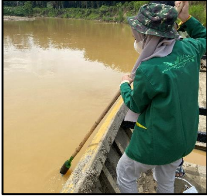
Gambar 1. Pengambilan sampel air dengan menggunakan alat water sampler sederhana
