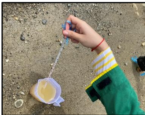
Gambar 3. Pengukuran suhu air menggunakan Thermometer batang
