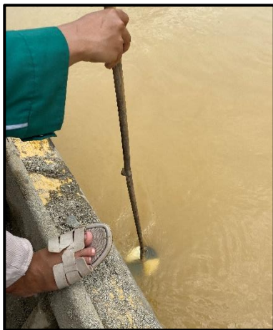
Gambar 2. Pengukuran kecerahan menggunakan Secchi Disk
