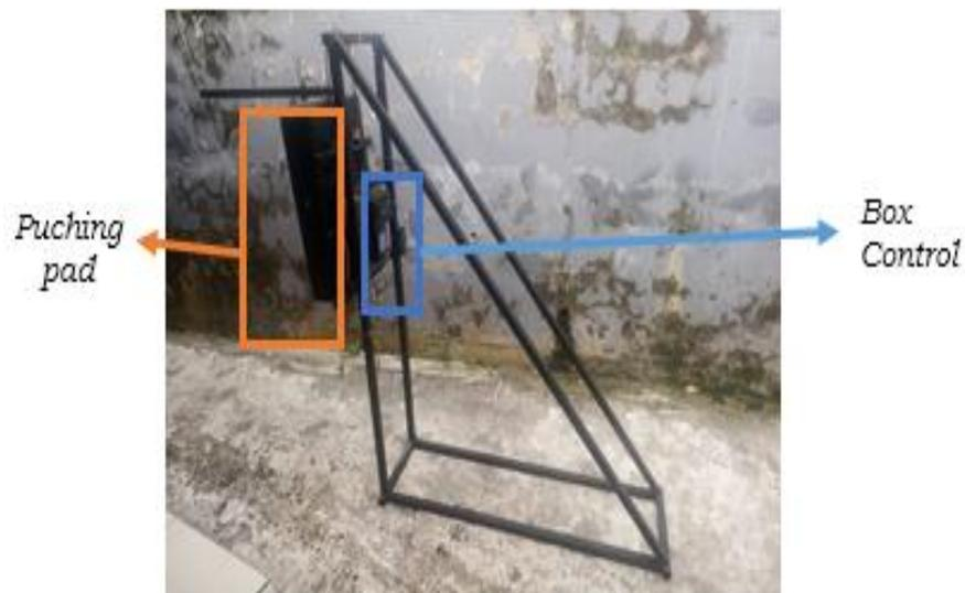
Gambar 7. Spesifikasi alat penghitung jumlah dan pace pukulan
