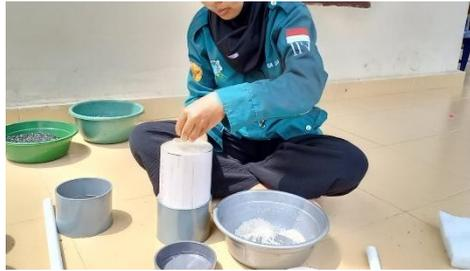
Masukan juga spons yang telah dipotong, pasir *silica* dan *zeolit* kedalam masing masing potongan pipa yang telah di siapkan
