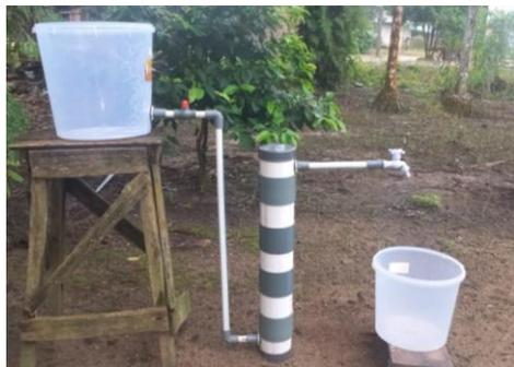
Rancangan filtrasi *upflow* yang dilakukan dapat dilihat pada Gambar di atas
