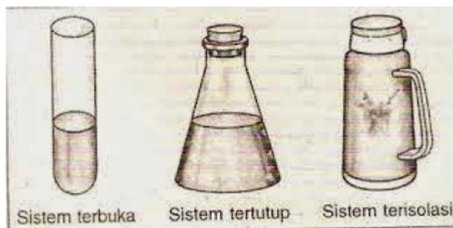
Gambar 2.3 Sistem Terbuka, Sistem Tertutup, dan Sistem Terisolasi
