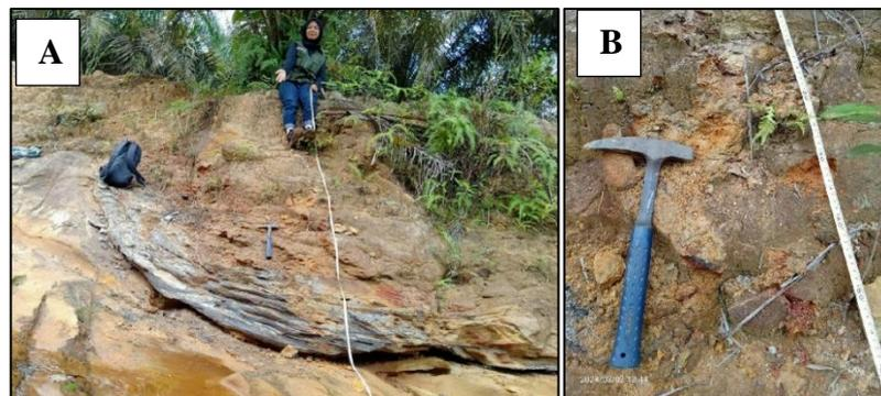
**Gambar 44.** Kenampakan Singkapan Batupasir Airbenakat dan (b) Foto dekat singkapan Batupasir Airbenakat, Arah Azimuth foto Baratlaut
