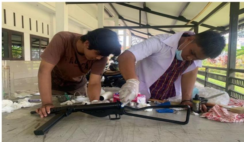
Foto 3. 43: pemberian lapisan minyak menggunakan minyak senjata
