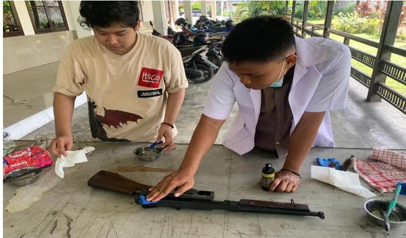
Foto 3. 19: Pemberian lapisan pelindung menggunakan minyak senjata dan liquid farafin
