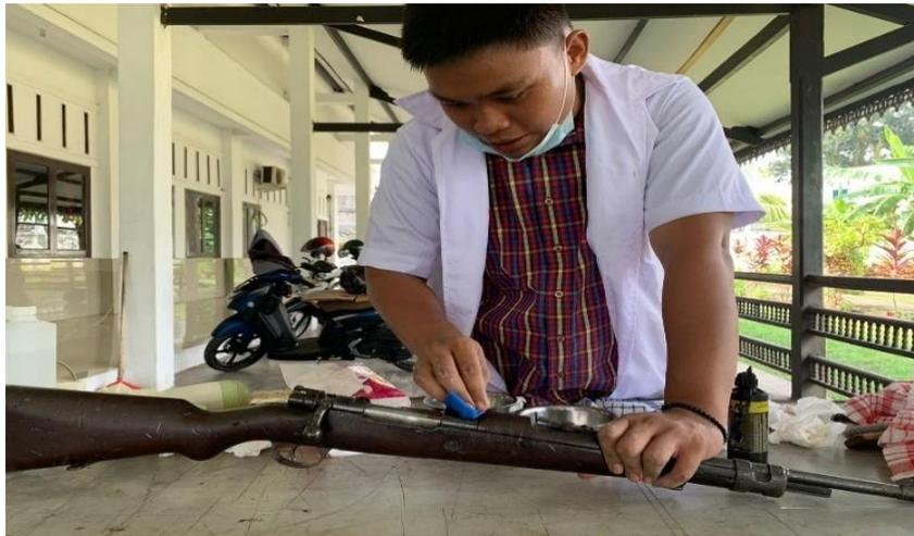
Foto 3. 27: pemberian lapisan lapisan minyak senjata dan cairan liquid farafin (Dok, M Alif zulkifli 2024)
