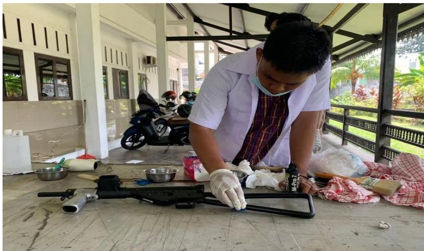
Foto 3. 35: pemberian lapisan pelindung menggunakan minyak senjata
