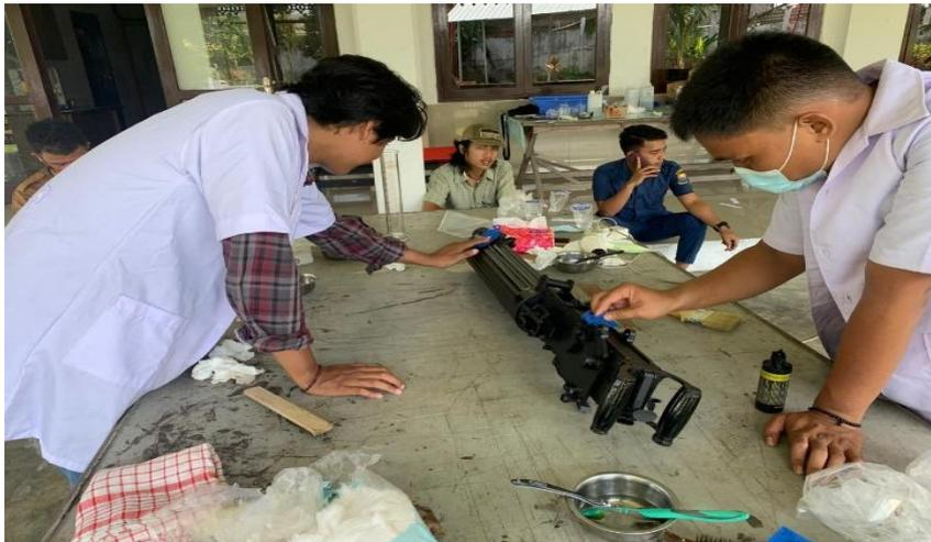
Foto 3. 11: Pemberian lapisan minyak menggunakan minyak senjata
