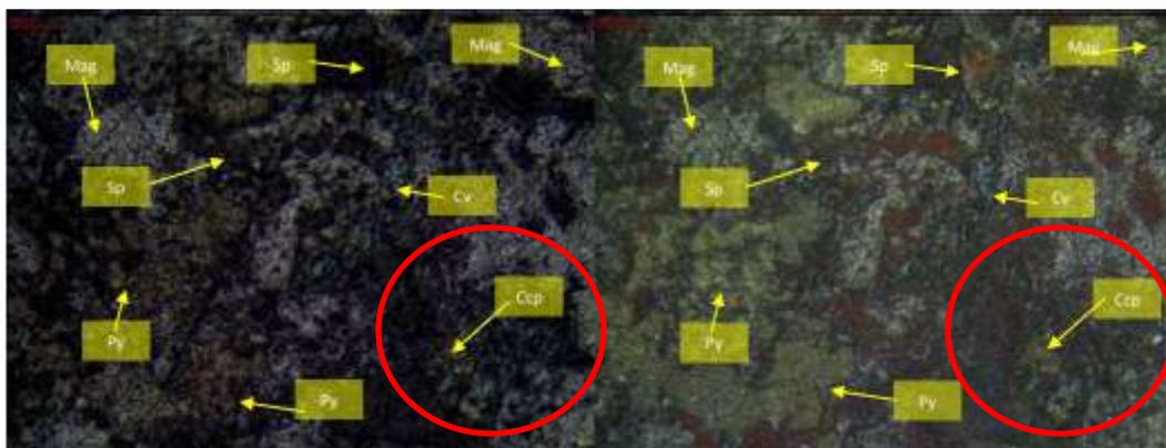
**Gambar 56.** Sayatan poles mineragrafi menunjukkan kehadiran mineral Sfalerit Kalkopirit (Ccp)
