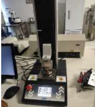
Gambar 17. Uji kekuatan Gel
