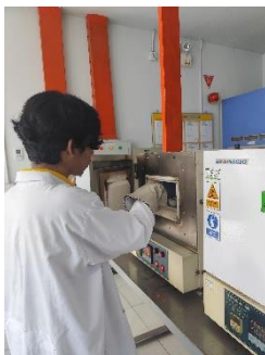
Dipanaskan sampel dengan Muffle Furnance selama 2 jam
