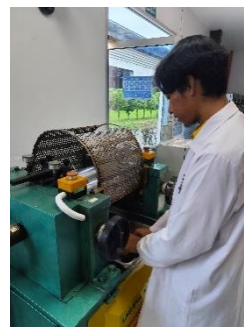
Digiling sampel dengan lab mill, tebal 2 mm
