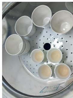
Didinginkan sampel dalam desikator selama 30 menit
