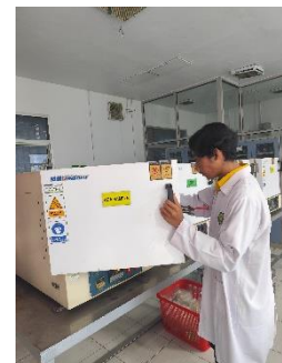
Dilanjutkan pemanasan dengan Muffle Furnance selama 30 menit
