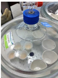
Didinginkan sampel dalam desikator selama 30 menit
