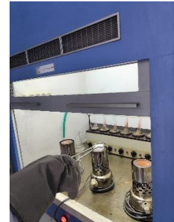
Dipanaskan sampel dengan elektrik bunsen
