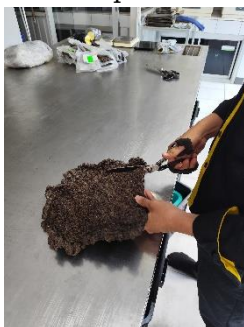
Digunting sampel 20 – 25 g untuk dilakukan pengujian
