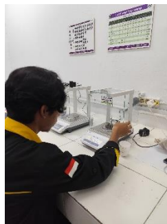
Ditimbang sampel ( m_{14} ), dihitung kadar zat menguap
