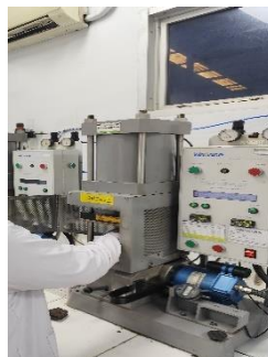
Ditutup platen dan jalankan motor
