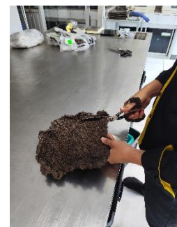
Digunting sampel 10 – 15 g untuk dilakukan pengujian
