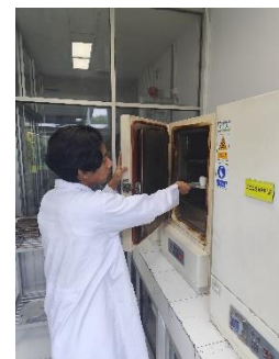
Dipanaskan sampel dengan oven ( 100^{\circ}\text{C} ) selama 2 jam
