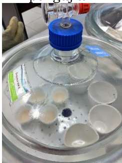
Didinginkan sampel dalam desikator selama 30 menit
