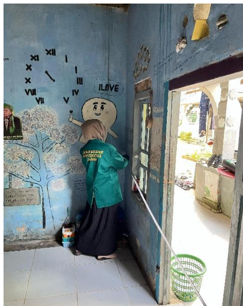
Gambar 4.2 Mengukur kepadatan Hunian kamar santri dengan mengukur panjang dan lebar kamar santri menggunakan alat roll meter (meteran).
