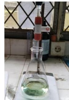
Gambar 44. Hasil akhir titrasi berubah menjadi hijau
