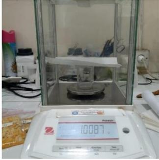
Gambar 36. Timbang sampel uji kadar lemak
