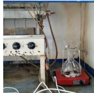
Gambar. 41. Destruksi didalam lemari asam
