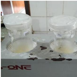
Gambar 30. Pemanasan dengan asam sulfat uji serat kasar
