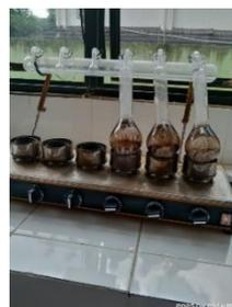
Gambar 8. Proses destruksi analisa protein
