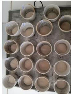
Gambar 2. Sampel kadar abu yang sudah ditimbang
