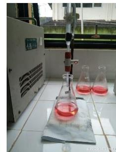
Gambar 6. Proses destilasi analisa protein, Proses ini terjadi perubahan warna dari warna pink jd hijau tosca
