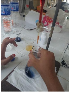
Gambar 19. Uji Vitamin C dengan metode titrasi
